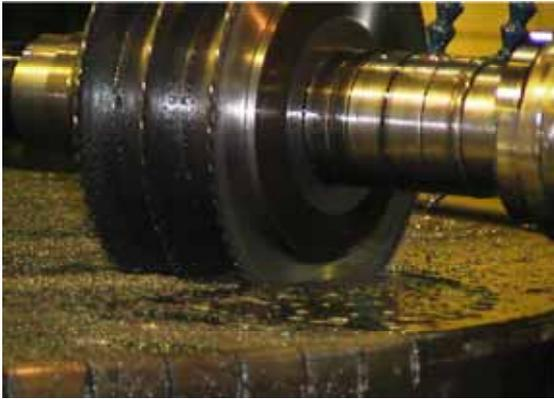
写真 - 1 切削油を使用して加工していた直後
